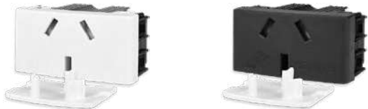
Tomacorriente IRAM 2071 10A./250 V~ con obturador de seguridad
